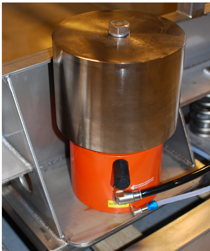
NTK 85 monteret med en massiv 41 kilo SM 85-5 svingmasse
